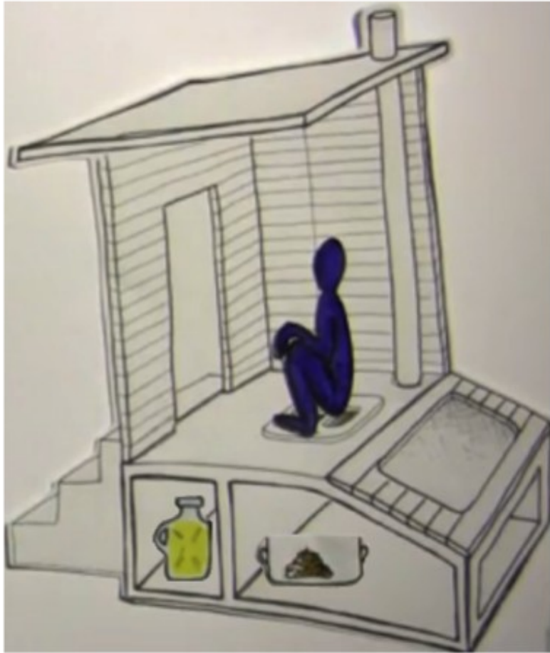
Skizze einer Hocktrockentrenntoilette, cc CaSa project
