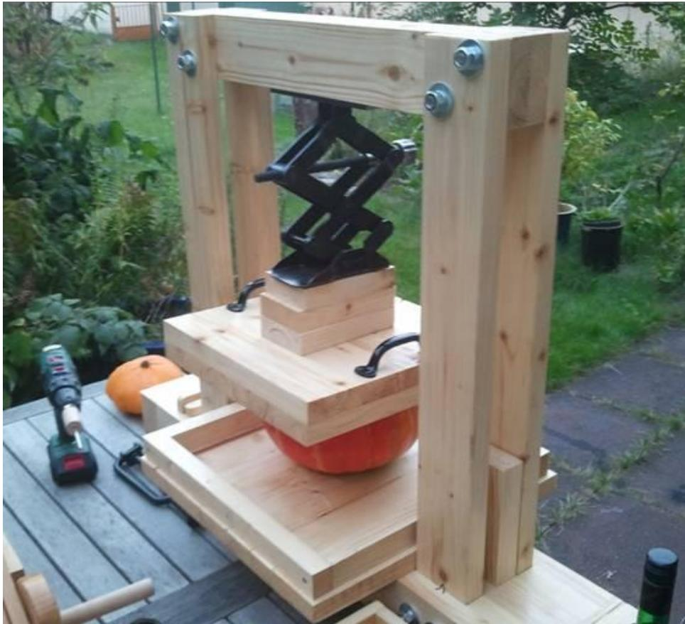
Saftpresse aus Holz mit Antrieb per Scherenwagenheber
