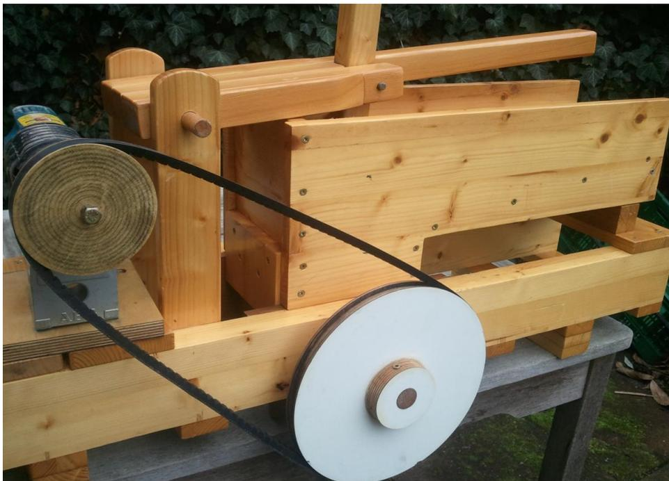
Obstmühle 2.0 mit Riemenscheiben und Antrieb per Bohrmaschine/E-Motor
