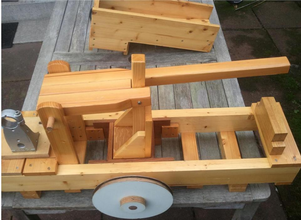
Der Hebelarm drückt die Äpfel mit dem Stampfer gegen die Walze (Rutsche entfernt)
