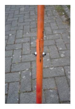
Der Vorbau des Lenkers kann normalerweise direkt in das Oberrohr eingeführt werden und durch das Festziehen des Spreizkonus am unteren Ende des Vorbaus festgemacht werden.
