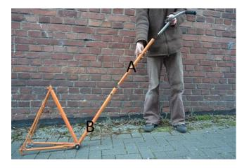
Jetzt wird senkrecht im Unterrohr (A) ein 10 bis 15 cm langer Schnitt mit einem Winkelschleifer gemacht. Das Oberrohr (B) des Fahrrads wird dann mit Kraft reingesteckt:
