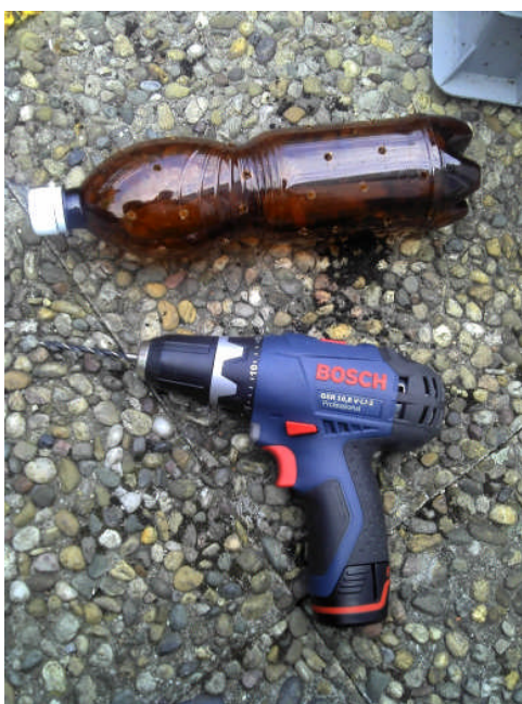
Flaschen rundherum mit vielen Löchern versehen (ein-/ Ausströmen von Wasser, Luft)
