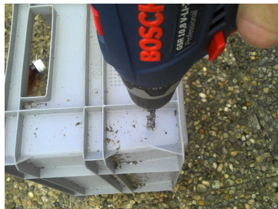
Überlauf bohren (ca. 1/5 der Kistenhöhe, auf jeden Fall unterhalb der Höhe der eingelegten Flaschen ! )
